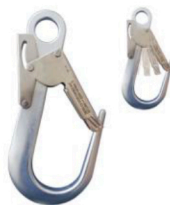
3805D aluminium Spécial échafaudage à verrouillage automatique ouverture 60mm 240 x 1 30mm, 430 gr. Résistance 22kN (2243kg)
