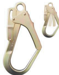
3805C acier zingué Spécial échafaudage à verrouillage automatique double-action ouverture 55mm 214 x 127mm, 510 gr. Résistance 23kN (2345kg)
